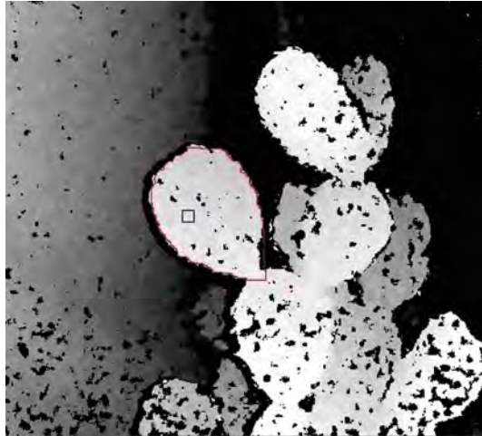
Figura 6. Mapa de profundidades de una planta de nopal en escala de grises obtenida con la cámara Intel® RealSense R200.
